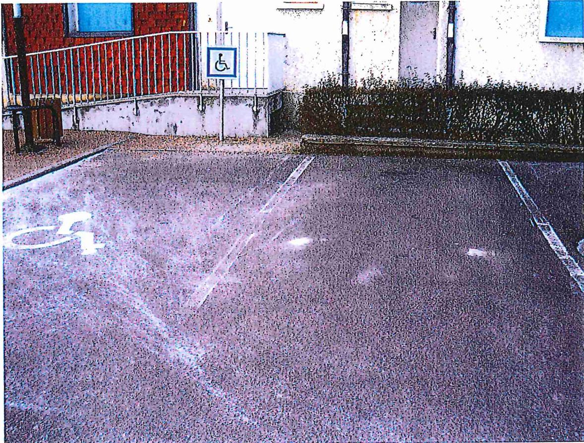
Place réservée handicapé à mettre en conformité (2,97 au lieu de 3,30 m de largeur)
